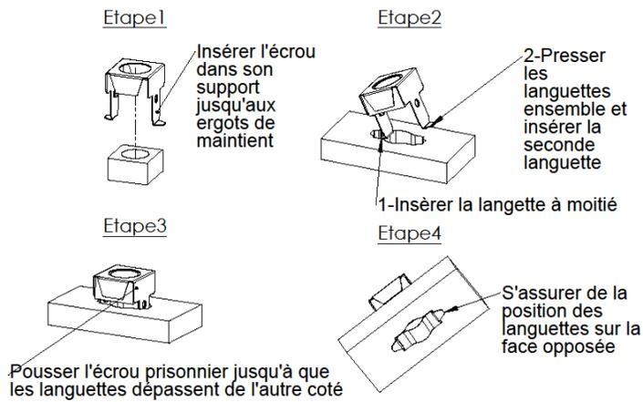
**Insertion d'un écrou prisonnier dans un logement d'extrémité
